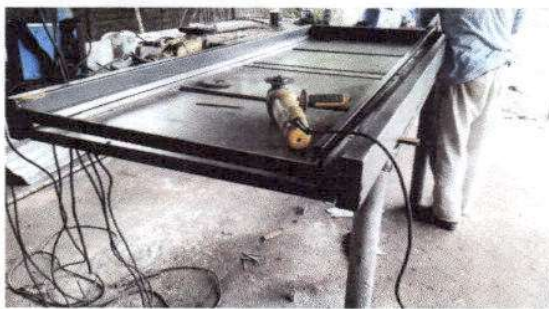
Foto 5: Fabricacion de puerta de metal de bodega
